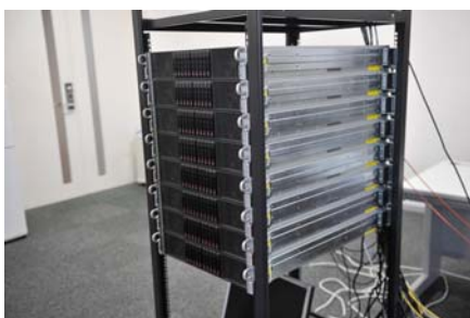
膨大な音響シミュレーションをこなす32GPUのクラスタ
